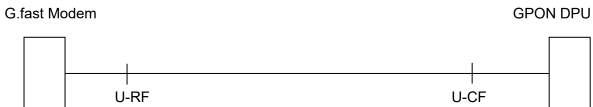
Abbildung 2.4.1 Schematische Darstellung eines G.fast FTTB Anschluss
