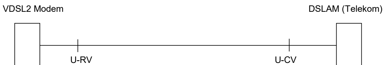
Abbildung 2.3.3 Schematische Darstellung eines VDSL2-Regio Anschluss
