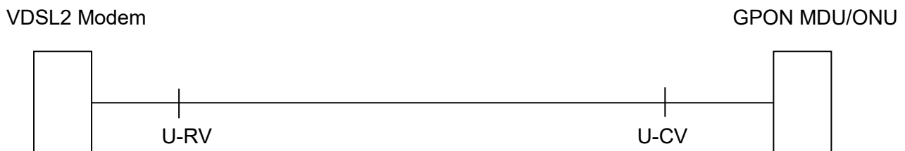
Abbildung 2.3.1 Schematische Darstellung eines VDSL2 FTTB Anschluss
