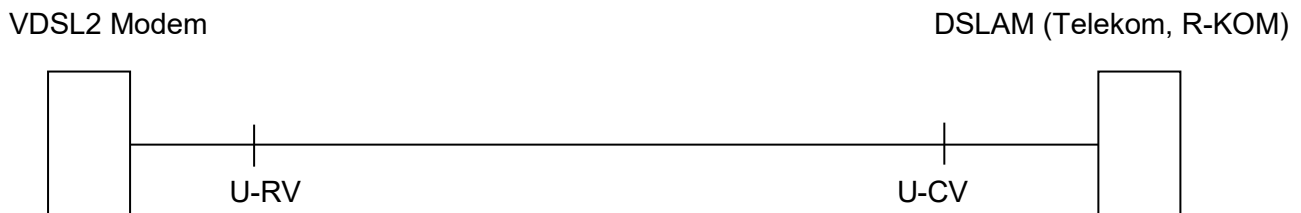
Abbildung 2.3.3 Schematische Darstellung eines VDSL2-Regio-Anschlusses
