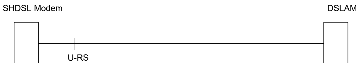
Abbildung 2.2.1 Schematische Darstellung eines SHDSL Anschluss
