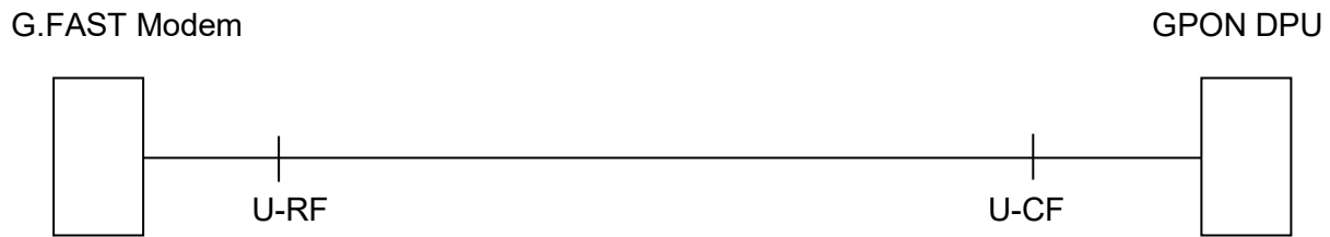
Abbildung 2.4.1 Schematische Darstellung eines G.FAST FTTB Anschluss
