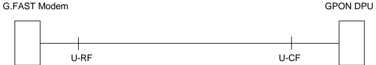
Abbildung 2.4.1 Schematische Darstellung eines G.FAST FTTB Anschluss
