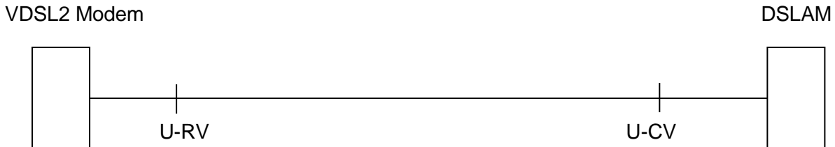
Abbildung 2.3.1 Schematische Darstellung eines VDSL2 FTTC Anschluss
