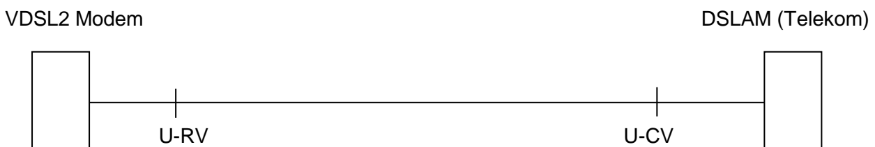
Abbildung 2.3.3 Schematische Darstellung eines VDSL2-Regio Anschluss
