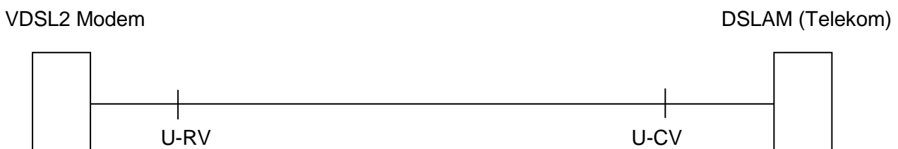
Abbildung 2.3.3 Schematische Darstellung eines VDSL2-Regio Anschluss
