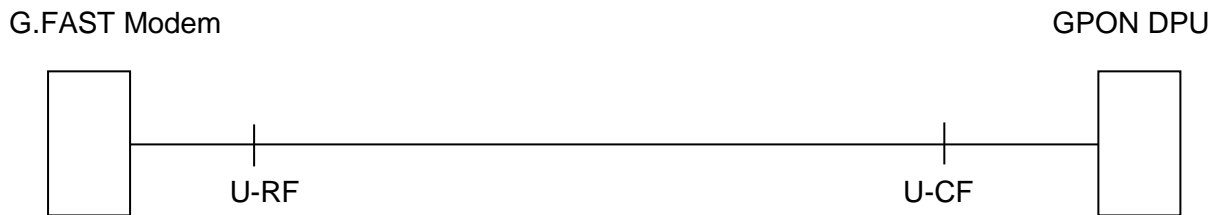
Abbildung 2.4.1 Schematische Darstellung eines G.FAST FTTB Anschluss
