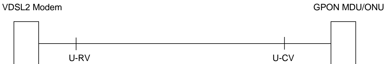
Abbildung 2.3.1 Schematische Darstellung eines VDSL2 FTTB Anschluss
