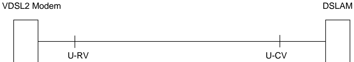
Abbildung 2.3.1 Schematische Darstellung eines VDSL2 FTTC Anschluss
