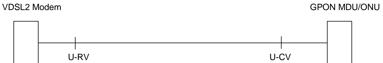
Abbildung 2.3.1 Schematische Darstellung eines VDSL2 FTTB Anschluss
