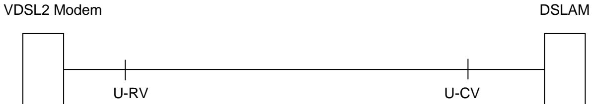
Abbildung 2.3.1 Schematische Darstellung eines VDSL2 FTTC Anschluss
