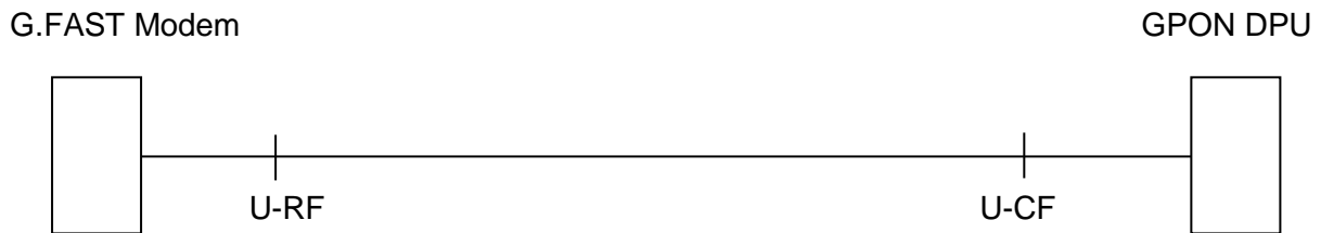
Abbildung 2.4.1 Schematische Darstellung eines G.FAST FTTB Anschluss
